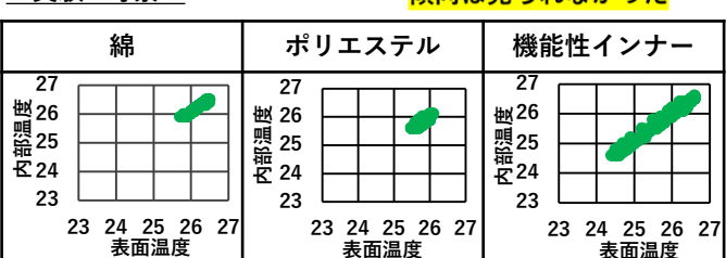
図5. 加湿あり実験1回目の3種類の布の表面温度と内部温度の相関のグラフ
