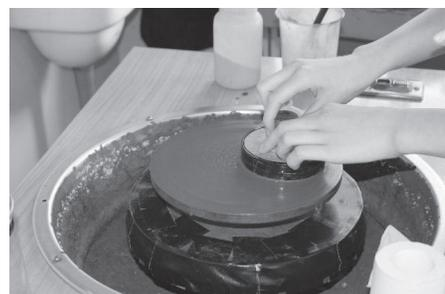
凸鉄皿による粗研磨
