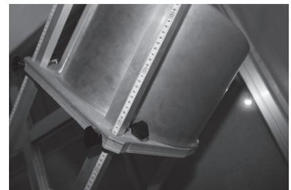
写真のように 25mm 厚の合板に直径 420mm の穴を空け、4本のフレーム合わせた穴を4ヶ所空けた。8mm のノブ付ボルトをストッパーとして使うためにツメ付ナットを外側からねじ込んだ。そして、移動させたときの光軸のずれを最小にするために、フレームには位置を合わせた目盛りが貼ってある。
