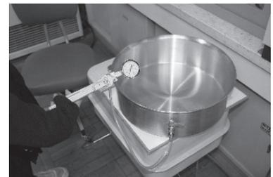
勿論、そのままではガラス板と寸胴鍋の間で空気漏れが起こり、吸引できないので、完全密着するようにワセリンを鍋の縁に均一に塗布して鍋とガラス板との密着度を上げた。ガラス板は歪みを避けるため周囲からは押さえていない。
