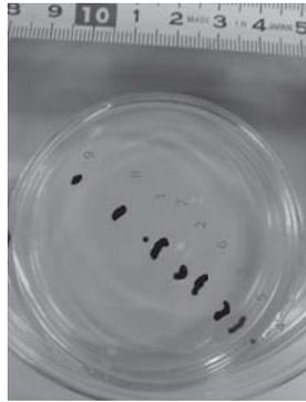
写真と一緒に写っているメジャーをもとに油滴の距離を測り、速度を求めた。文献によると、油滴の速度はほぼ一定であると記述されている。私たちの実験結果でも同様の結果が得られた。
