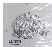
図9. 陽極半径27mm、300s通電で形成された金属葉
